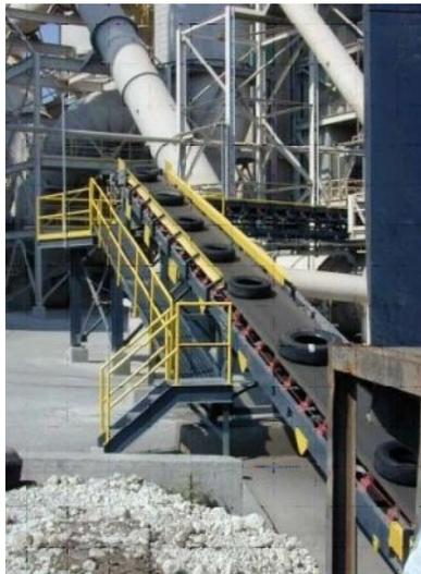
Foto de una banda de alimentación de llantas al calcinador de un horno de clínker
